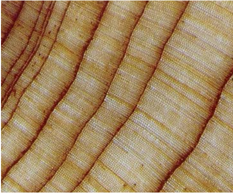
De algemene structuur van naaldhout, gezien op het dwarse vlak door een sterk vergrotende loep (2).
